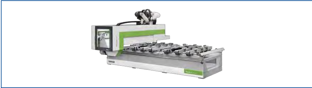
Abbildung 124: Beispiel für Universalmaschine mit 4-Achstechnik, © Biesse Deutschland GmbH
