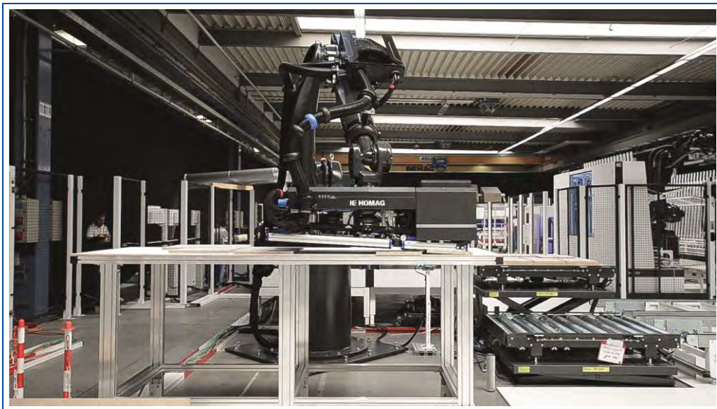
Abbildung 130: Einsatz eines Roboters für die Beschickung eines Bearbeitungszentrums © HOMAG Group AG
