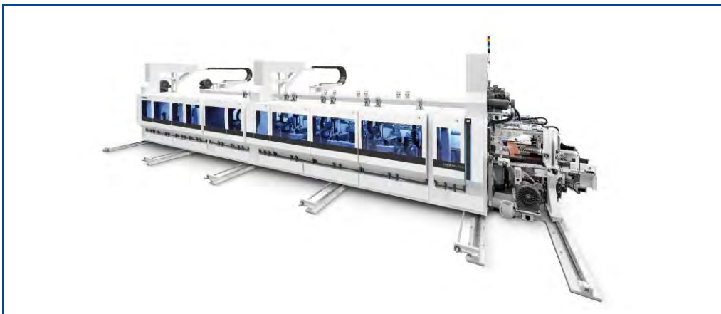
Abbildung 117: Doppelend-Profiler mit umfangreicher Ausstattung und sehr hoher Leistung für den Fußbodenbereich © HOMAG Group AG
