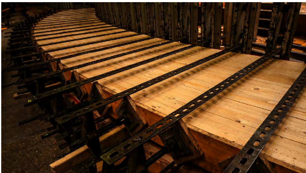
Abbildung 22: Herstellung von Brettchichtholz (Pressbett), © Mayr-Melnhof Holz (MM Holz)
