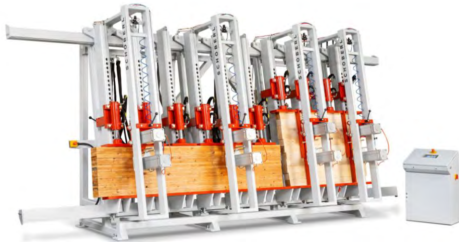
Abbildung 14: handwerkliche vertikale Presse, Lamellierpresse © Maschinenfabrik Rudolf Schöberl Ges.m.b.H. & Co.KG., Austria
