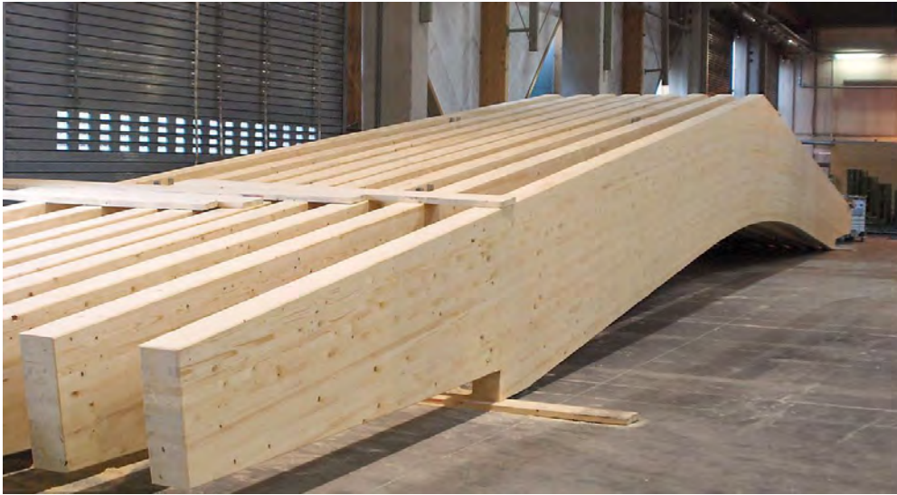
Abbildung 19: Individuell hergestellte und berechnete Brettschichtholz-Leimbinder, © binderholz
