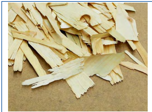
Abbildung 1: Strands für die Herstellung von OSB-Platten, © BÜTTNER Energie- und Trocknungstechnik GmbH
