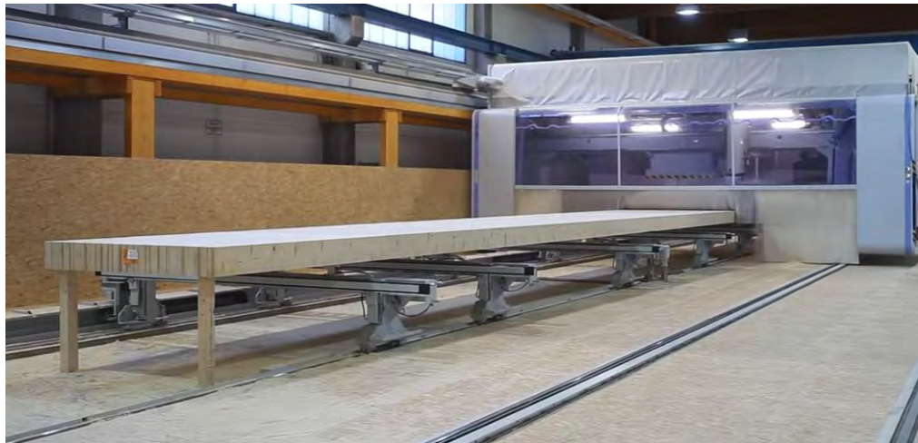
Abbildung 23: Portal-Bearbeitungszentrum für den Abbund von Leimbändern
