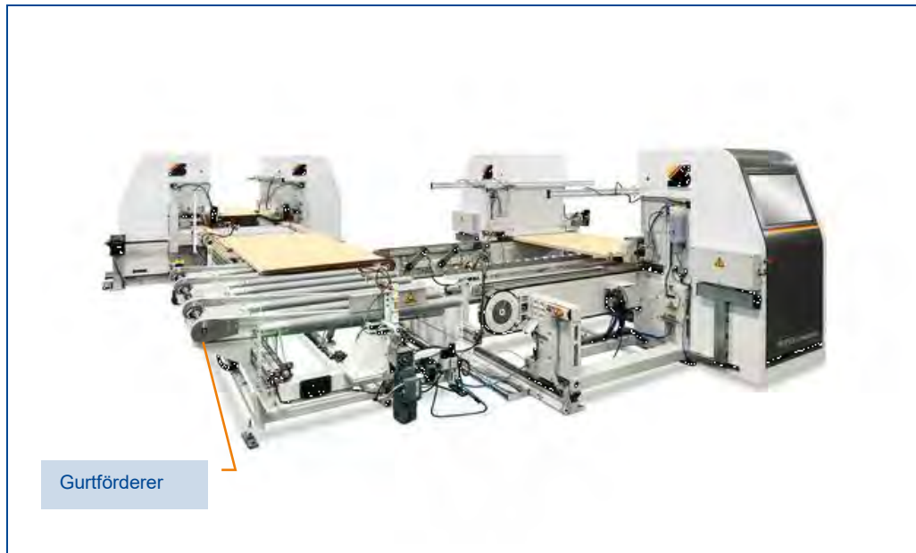
Abbildung 118: Doppelendprofiler Winkelanlage für die Sperrholz-Formatierung, © SCHWABEDISSEN Maschinen GmbH
