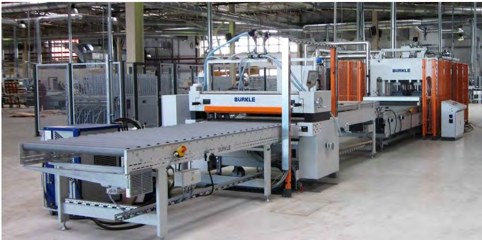
Abbildung 15: industrielle horizontale Pressenanlage, © Robert Bürkle GmbH
