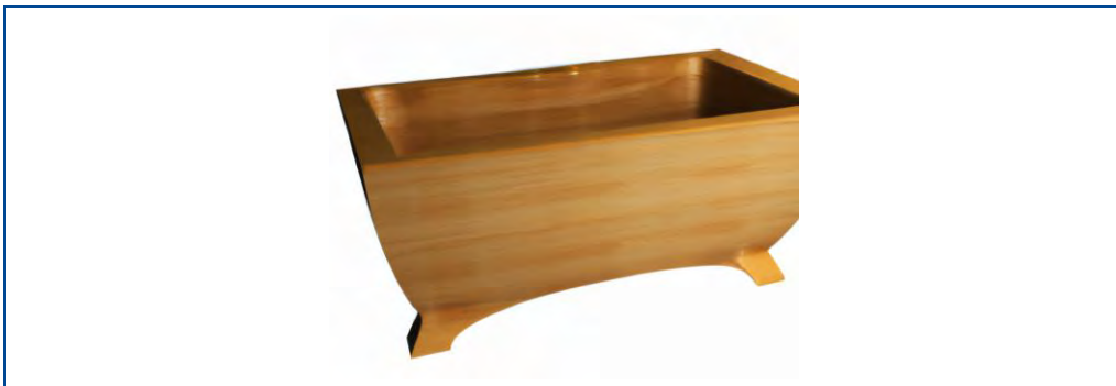
Abbildung 125: gefrästes 5-Achs-Produkt (Badewanne aus Holz)
